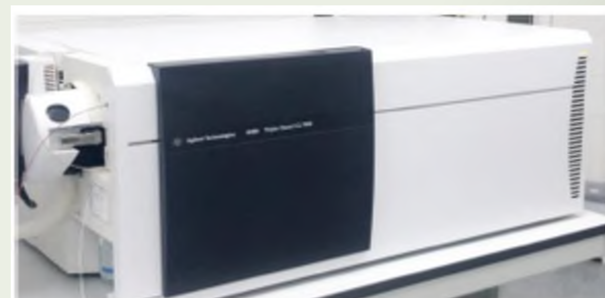
Хроматограф жидкостный Agilent 1260 Infinity (US83870021) с Triple Quadrupole 6460A LC/MC System
