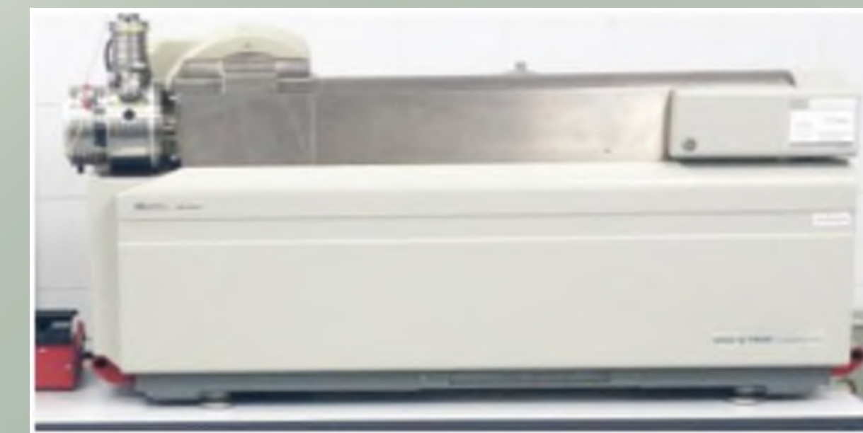
Хроматограф жидкостный Agilent 1200 с Triple Quadrupole SCIEX API 4000 QTRAP
