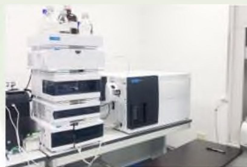
Хроматограф жидкостный Agilent 1260 Infinity II (SG2111G206) с Triple Quadrupole 6470 LC/MS System
