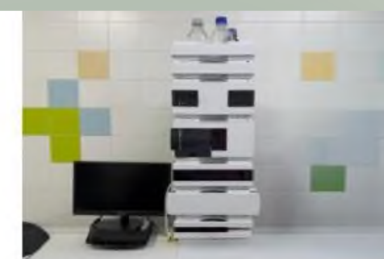
Жидкостной хроматограф с спектрофотометрическим и флуориметрическим детекторами Agilent 1200
